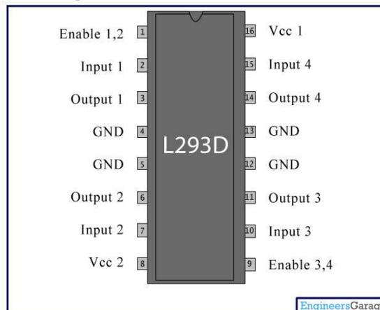
Fig.no:1.3 Motor Drive diagram
