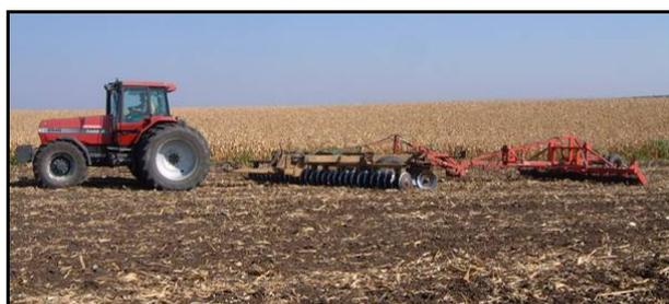
Fig. 1 Rába-IH disc harrow + Güttler roller
