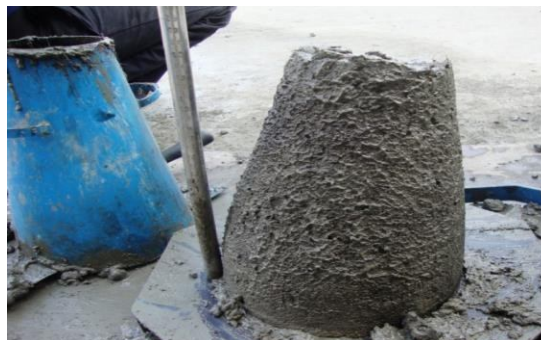
Fig: Slump test
